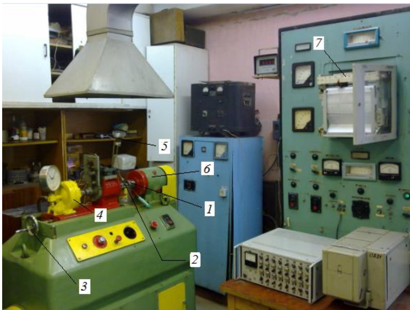
Рис. В.3. Машина тертя МФТ-1 (кафедра машинобудування та інженерної механіки ДВНЗ «Український державний хіміко-технологічний університет», м. Дніпропетровськ):
